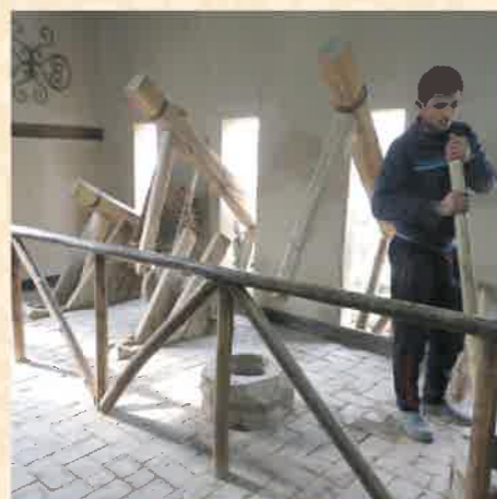
メロス工房では水車の動力を利用して紙の原料を叩解しています
