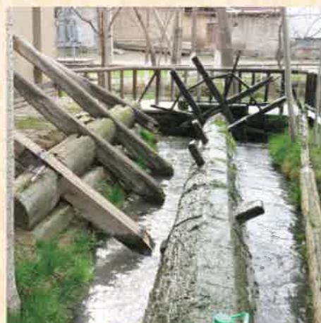
メロス工房では水車の動力を利用して紙の原料を叩解しています
